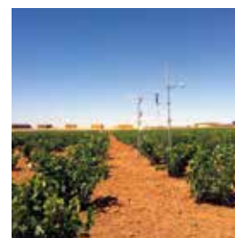
El método Eddy Covariance constituye una forma de medida de flujos mediante un anemómetro ultrasónico y un analizador de gases infrarrojo (IRGA) (Copyright: AgriSat)
